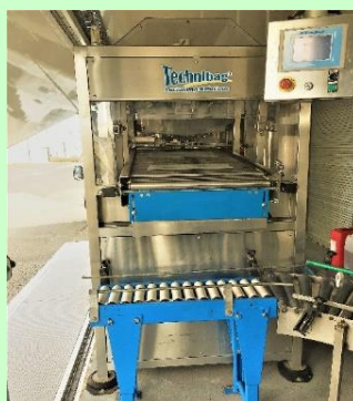
Remplissage des poches en format 3, 5 ou 10 L. Inertage à l'azote.
