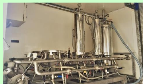
Filtre à cartouches. Combinaisons possibles avec du 3µ et 0,45µ sur demande au préalable.
