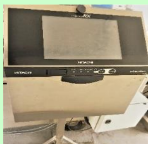
2 imprimantes Hitachi. Marquage à l'encre du code barre + n° de lot possible.
