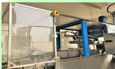
Pliage, collage et étiquetage des cartons en ligne
