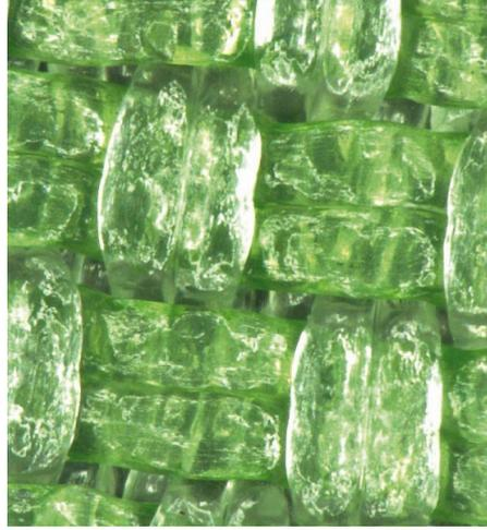
Abb. 3: Abströmseite eSan-Filtertuch mit Flechtstruktur und einer mittleren Porenweite von 60 µm
