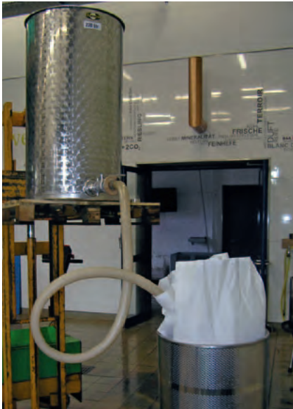
Einfüllen des Filterhilfsmittel-Trub-Gemisches in die Hydropresse
