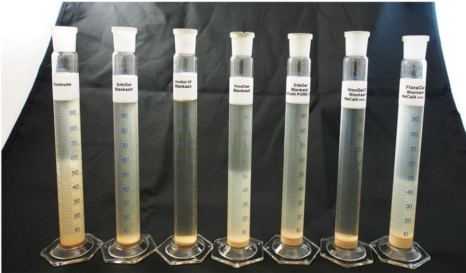
Abb. 1: Klärungsvorversuch nach einer Klärungsphase von 20 Stunden
