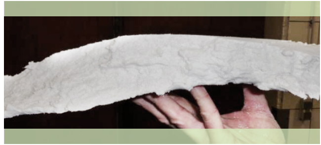
Abb. 4b Ausgepresster Filterkuchen von Doppelsalz-Entsäuerungs-Kristalltrub
