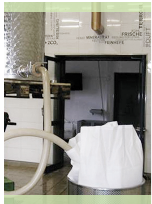
Abb. 2 Einfüllen von Filterhilfsmittel-Trub-Gemisch in Filterbeutel
